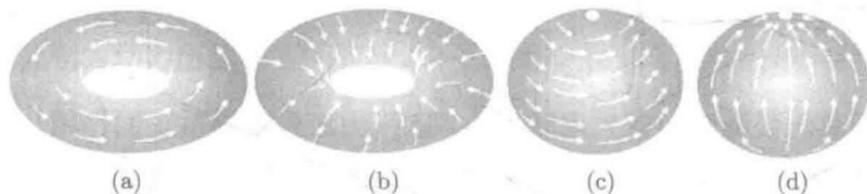
图 4-2-1 不同封闭拓扑面上的向量场
