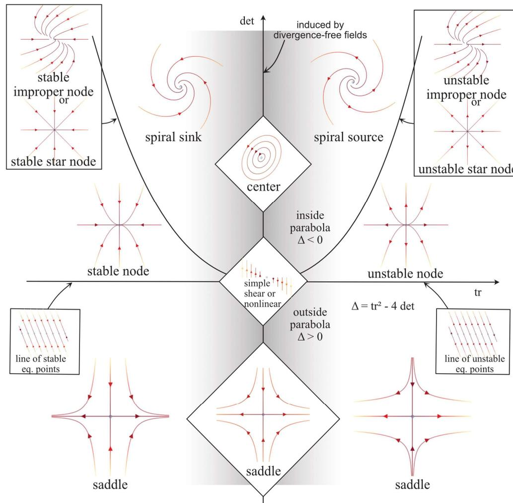
Fig. 二维自治动力系统根据平衡点的 Jacobian 的经典分类
