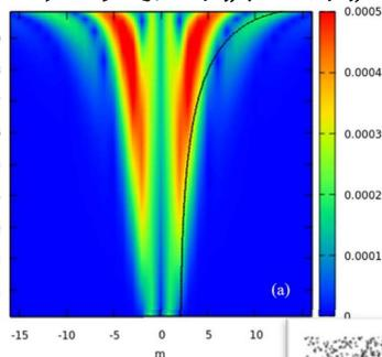
Fig. 典型的磁谱分析, EAST上的扰动场径向分量的 Fourier 磁谱  $n=2$ , RMP 偶宇称 ( $I_{RMP} = 5kA$ )
